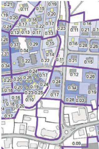
Abb. 3: Ausschnitt Plan bestehende ÜZ Hauptbauten
